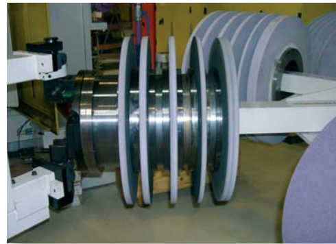
Abb.: Schleifscheibenmagazin und -wechselhilfe
